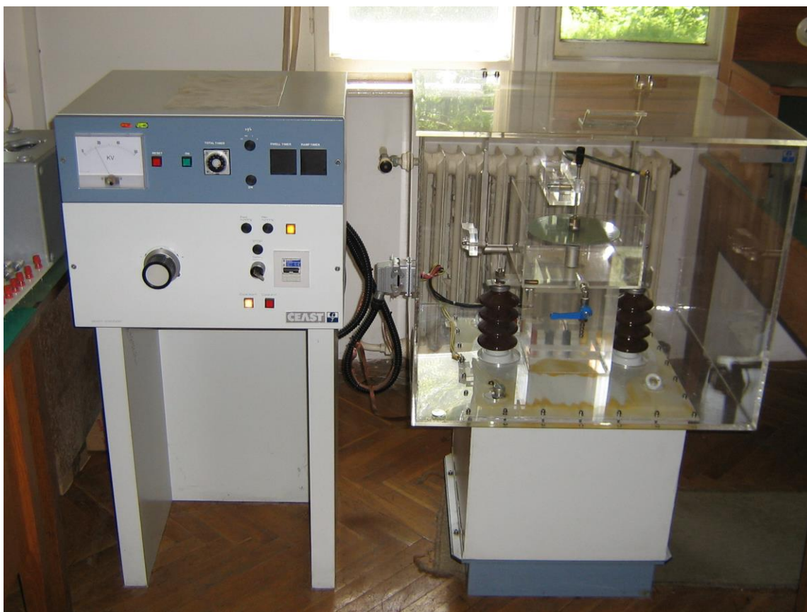
Slika 3- Fotografija ispitne aparature za utvrđivanje dielektrične čvrstoće čvrstih izolacionih materijala
